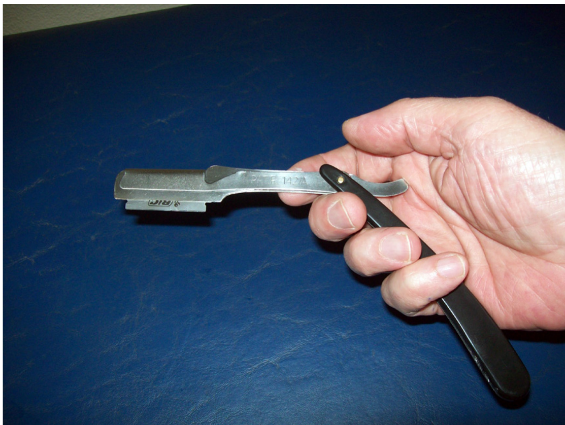
FIGURA 6: Suporte tipo navalha (porta-lâminas descartáveis) usado para fazer os cortes de tecido.
